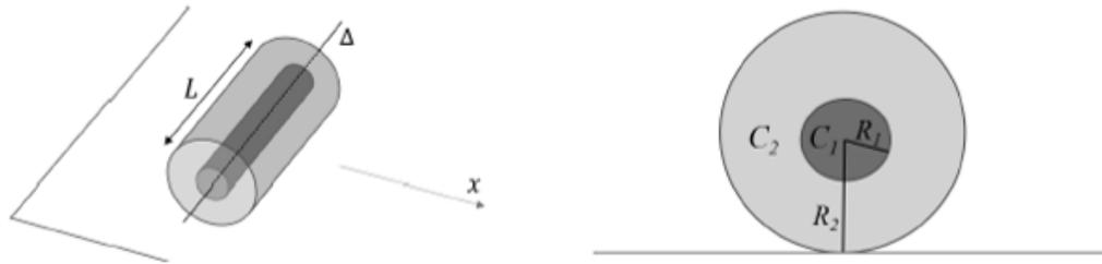
**1a** Calculez le moment d'inertie  $I$  du rouleau pour une rotation autour de l'axe  $\Delta$ .  $I$  sera exprimé en fonction de  $R_1$ ,  $R_2$ ,  $\rho_1$ ,  $\rho_2$ , et  $L$ . On rappelle que le moment d'inertie d'un cylindre plein de rayon  $R$  et de masse  $M$  pour une rotation autour de l'axe  $\Delta$  est  $I_{cm} = \frac{1}{2}MR^2$ .
