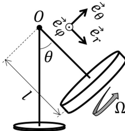
Une toupie, soumise au champ de la pesanteur  $g$ , est pendue par son axe de rotation sur un socle. Son point d'attache  $O$  est à une distance  $l$  de son centre de masse. La toupie est en rotation rapide autour de son axe à vitesse angulaire  $\Omega$  constante. Le moment d'inertie de la toupie autour de son axe est noté  $I$ . Le sens de la rotation de la toupie est schématisé ci-contre (les points de la toupie proches de vous montent vers la droite).
