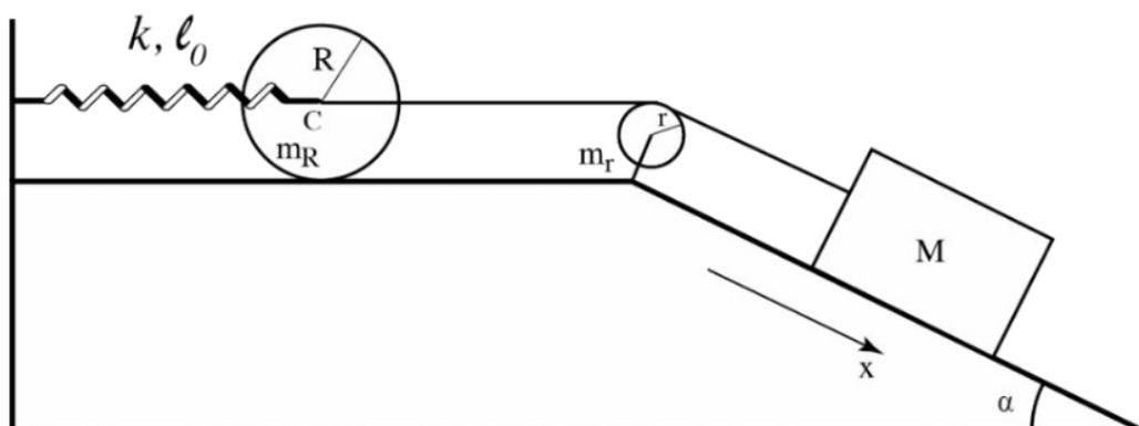
On ajoute un élément dans le système : un ressort de longueur au repos  $l_0$  et de raideur  $k$ . Le ressort est fixé d'un côté à un support ( $A$ ) et de l'autre côté à l'axe de la roue ( $C$ ), comme indiqué sur le schéma ci-dessous.
